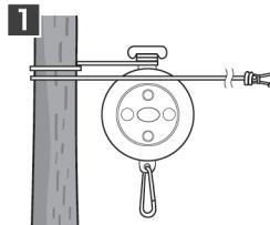
ストッパーにロープを2~3回巻き付け、ロープを必要な長さに引き出し、木に巻き付けてください。
